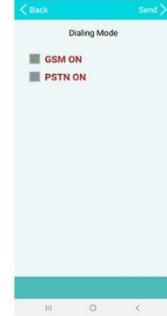
نکته: در این برنامه جهت تماس با شماره های تعریف شده در پنل میتوان از سیمکارت داخل دستگاه یا از خط تلفن شهری وصل شده به پنل مرکزی استفاده کرد.
